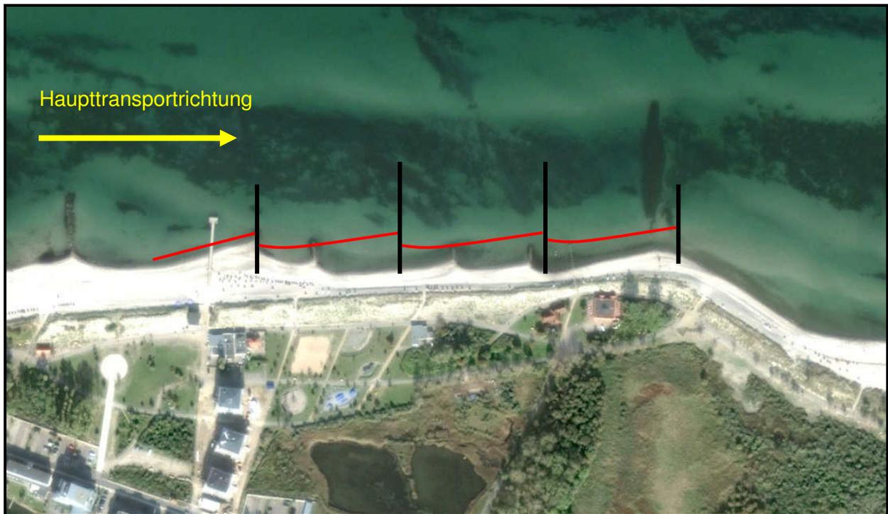
Abbildung 13: Mögliche Entwicklung der Wasser-Land-Grenze im Bereich des Testbuhnenfeldes 1 [Bildquelle: GOOGLE EARTH]
