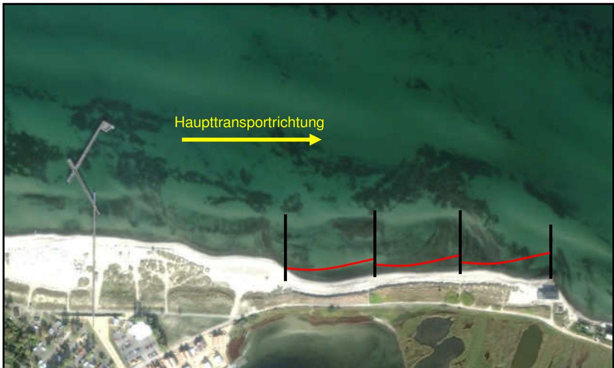
Abbildung 14: Mögliche Entwicklung der Wasser-Land-Grenze im Bereich des Testbuhnenfeldes 2 [Bildquelle: GOOGLE EARTH]
